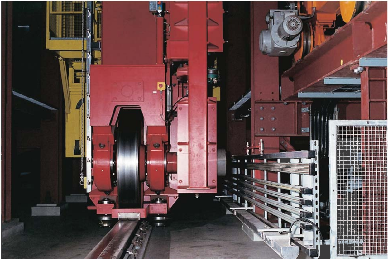
VAHLE滑线系统与SMG 数据传输系统，应用于自动仓储车间
