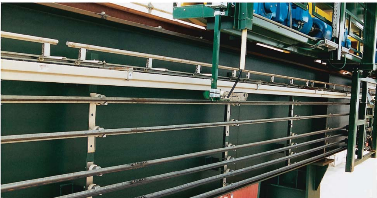
天线支撑臂组装于大型起重设备
